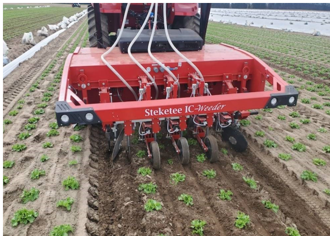
A Steketee IC Weeder - automated 8 row hoe
